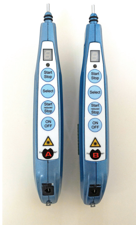
圖一 雷射針灸儀器：A 為偽雷射針灸儀器（安慰組），外觀重量及操作治療模式均與真雷射針灸儀器一致且無法分辨，惟無法發出低能量雷射；B 為真雷射針灸儀器（實驗組）。
